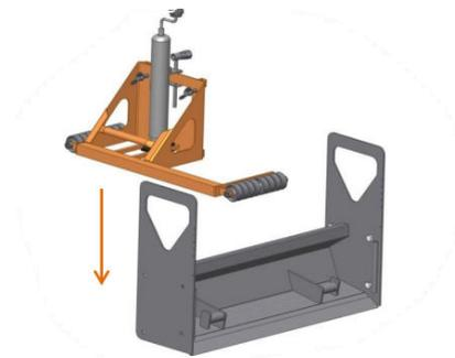
**3.** A altura a ser removida é lida na escala da peça intermediária (1). A borda superior do sistema de rodagem indica a medida ajustada (2). O sistema de rodagem é fixado à peça intermediária com os dois parafusos borboleta (2).
