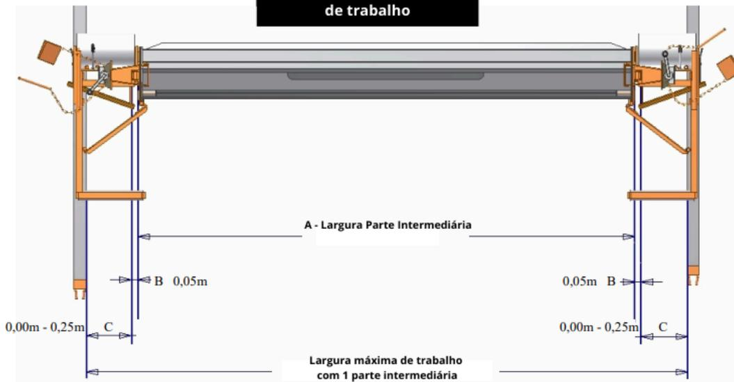
**A 1. Largura da parte intermediária + 2. Largura da peça intermediária +** + **B Por lado do sistema de movimentação 0,05 m** + **C Posição das tampas por lado 0,00 m - 0,25 m**
