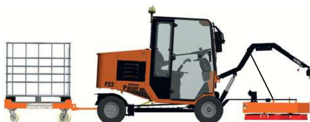
Dispositivo de enchimento de juntas de pavimentação com caminhão-pipa e tanque de água
